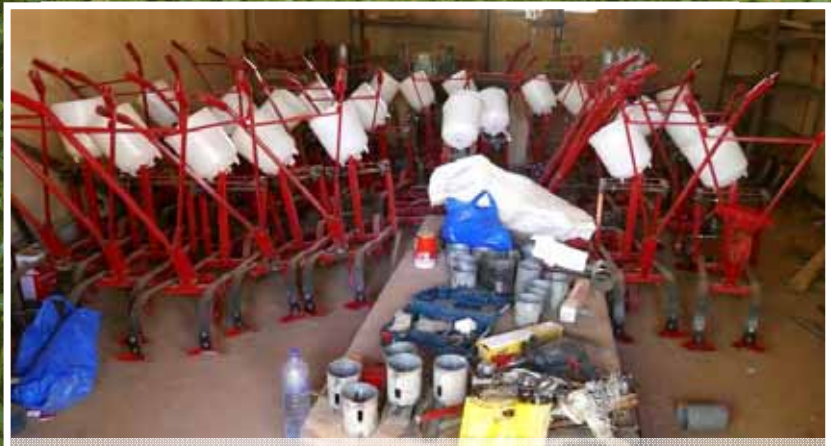
Lokal produziertes Düngelplazierungs-Saatgerät für Getreide & Leguminosen (Saria, Burkina Faso)
