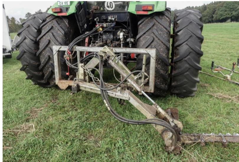
Abb. 14: Schlepper mit Doppelreifen und einem Doppelmessermähwerk im Heckanbau.
