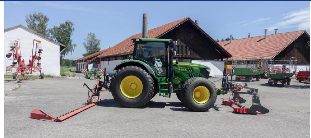
Abb. 13: Schlepper der Bayerischen Staatsgüter (BaySG) mit den für das Projekt „Moor-KULAP“ beschafften Gürtel-Flotationsreifen und Doppelmessermähwerken.
