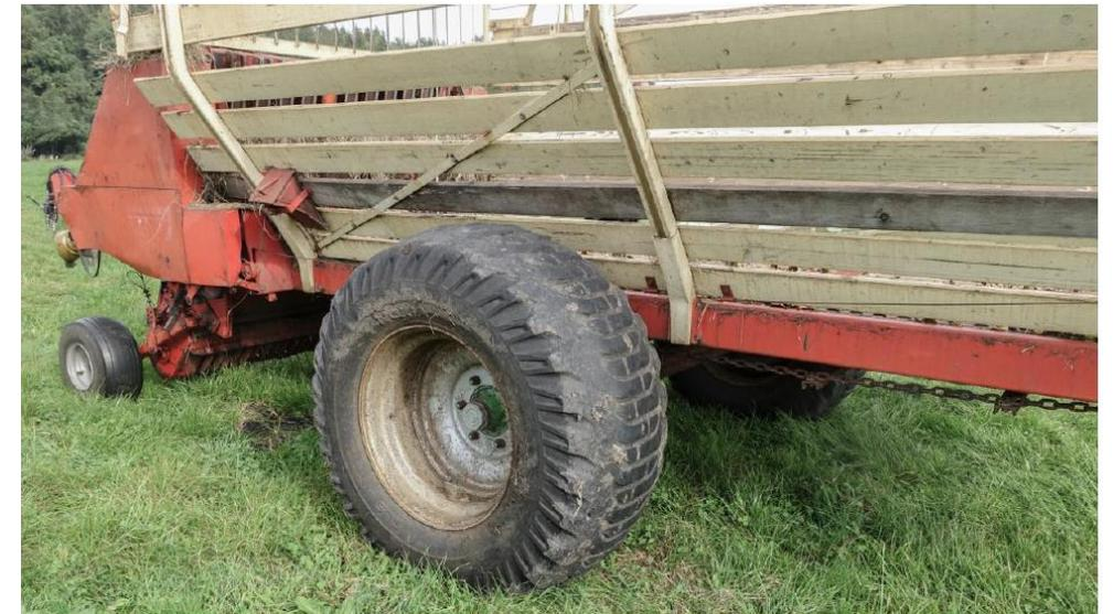
Abb. 15: Ladewagen mit Ballonreifen an der Aufnahmewelle und einer umgebauten Achse mit großen Reifen eines ehemaligen Güllefasses.
